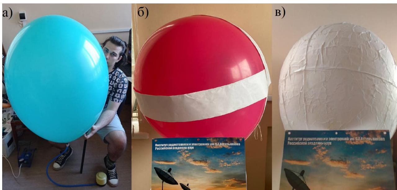
Рис. 1. Этапы создания макета: а) определение формы и максимальных размеров воздушного шара; б) шар с бандажами для коррекции формы; в) сфероид из папье-маше.
